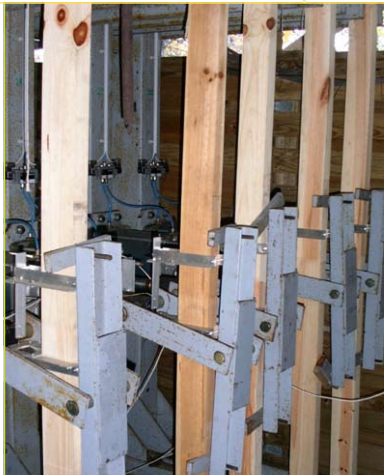
Langdurige mechanische beproeving van houten balken om constructieve eigenschappen van het hout te bepalen.
