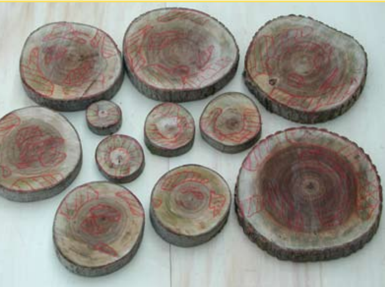
Kleurtechnieken om reactiehout bij bomen zichtbaar te maken en een inschatting te maken naar de invloed op de technische verwerking van dit hout.
