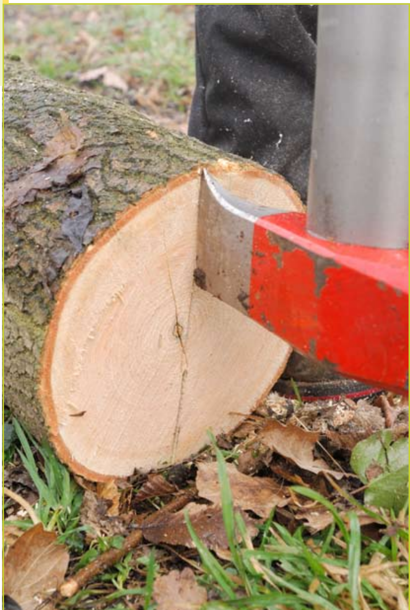
Een stompe kliefhamer dient om houtvezels uit elkaar te splijten. Op de foto zie je een bijna gespleten stamstuk es.
