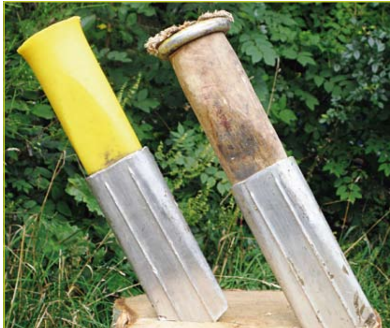
Aluminium wiggen met een plastic en houten inzetstuk zijn het beste van twee werelden.
