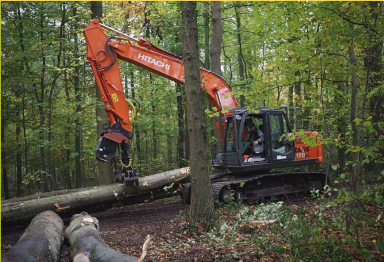
Figuur 3: De rupskraan manoeuvreert vlot met de stammen. Vooraan op de kraanarm is duidelijk de lier te zien (zwart bakje).
