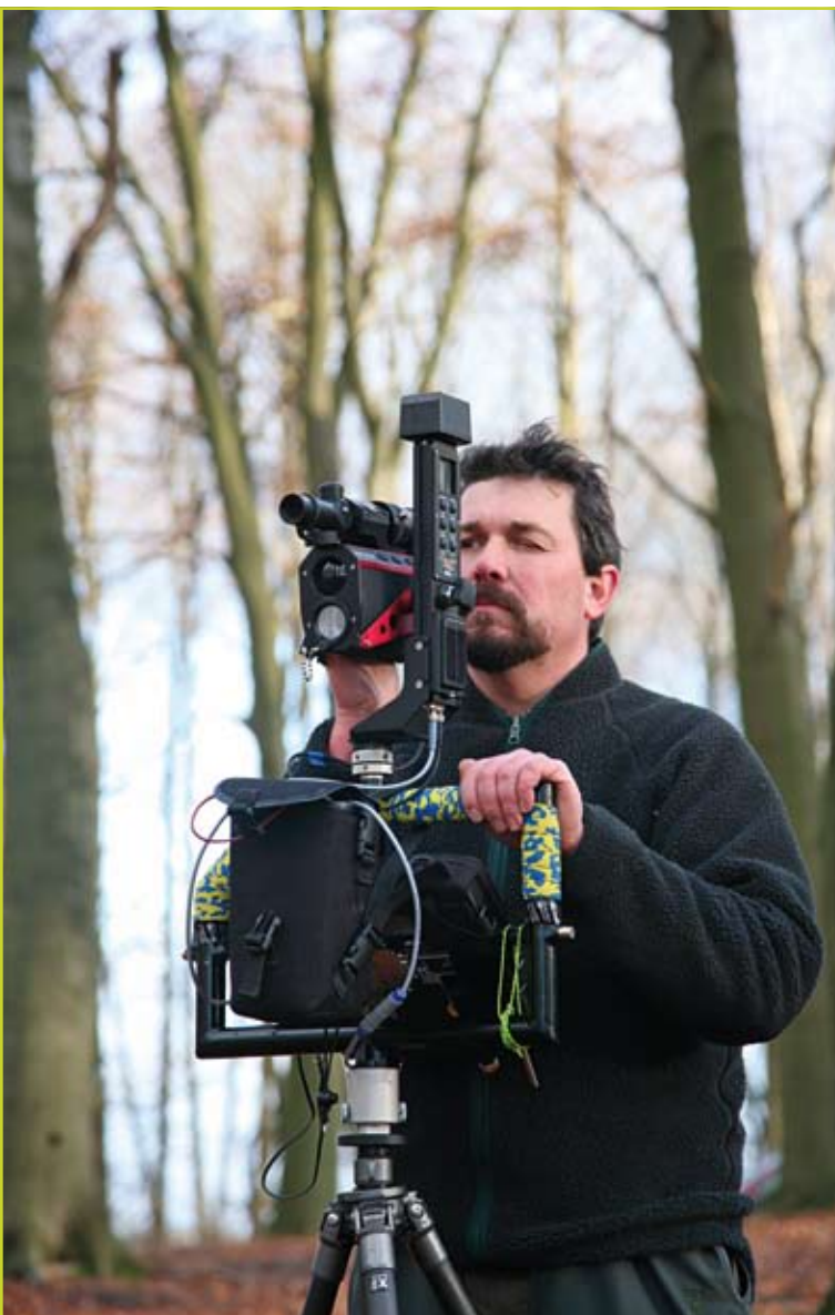
Figuur 3: Het FieldMap-systeem integreert GPS, elektronisch kompas, laser-afstandsmeter, clinometer, en veldcomputer voor een optimale terreinefficiëntie.
