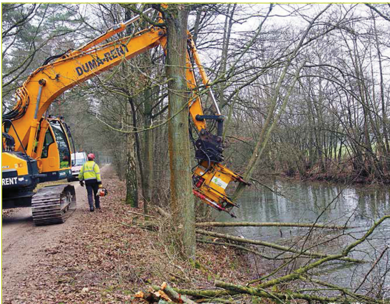
Oogsten van de bomen met rupskraan met hydraulische zaag.
