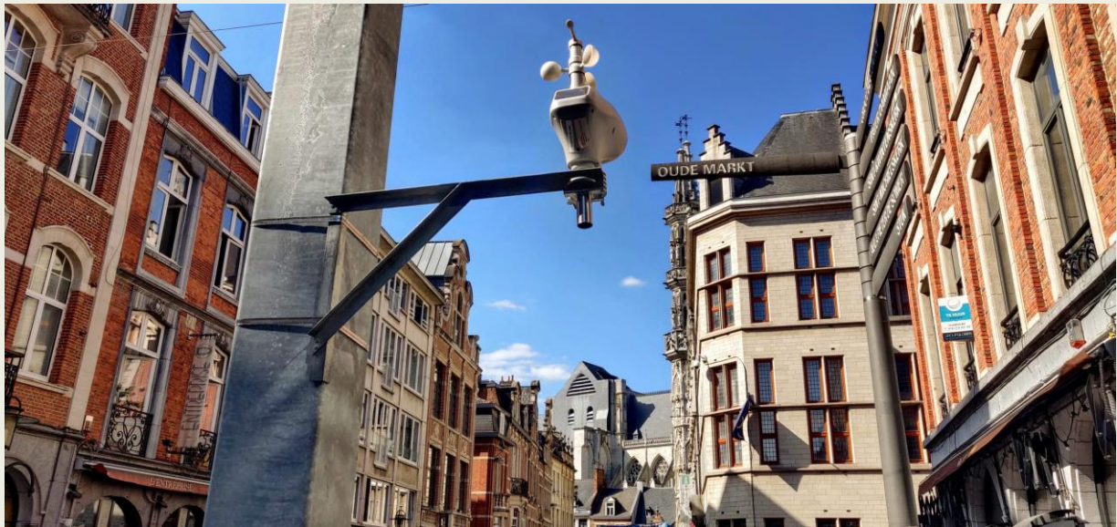
Figuur 1: Voorbeeld van een Leuven.cool weerstation geïnstalleerd in de Naamsestraat, Leuven. Het weerstation meet luchttemperatuur, relatieve vochtigheid, windrichting, windsnelheid, neerslag, radiatie en UV (credit: Maarten Reyniers).
