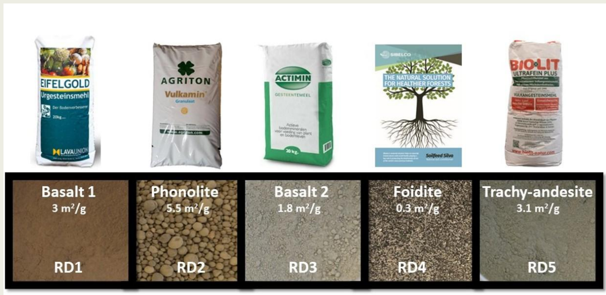
Figuur 2: Foto's van de gekarakteriseerde en toegepaste commerciële steenmeelproducten, het steenmeeltype, het specifiek oppervlak per gram (m 2 /g), de merknaam, en de codering gebruikt in deze tekst RD1 tot RD5 (Rock Dust 1 tot 5).
